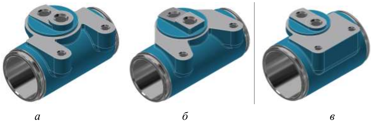
Рис. 4. Вплив зміни параметрів на геометрію моделі корпусу
