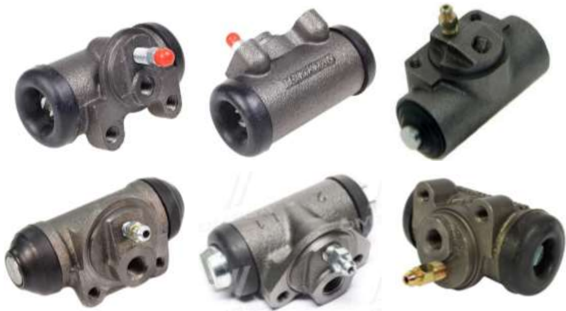
Рис. 2. Варіанти геометрії існуючих колісних гальмівних циліндрів
