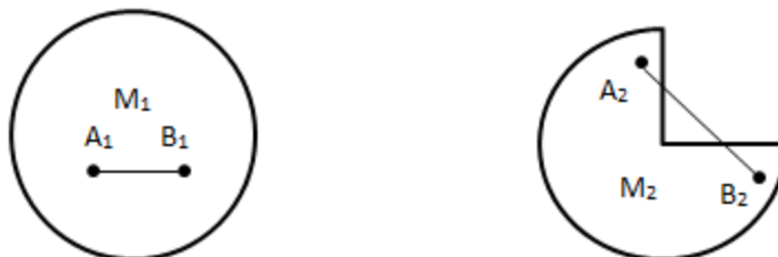
Рис. 1. Приклади множин: M_1 – опукла; M_2 – не опукла Зображення на рис. 1 означає, що M_1: M_2 \subset E^2 :
