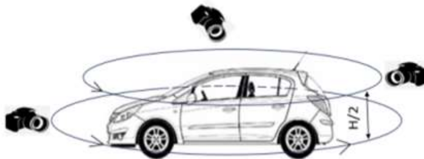
Рис. 7. Схема послідовності зйомки при фотограмметрії
