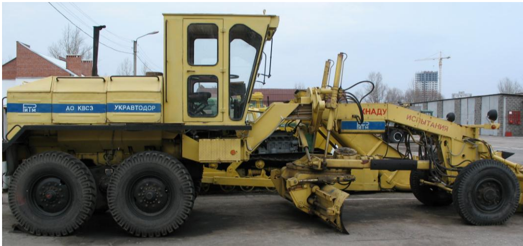
Рис. 2. Автогрейдер середнього класу ДЗк-251
